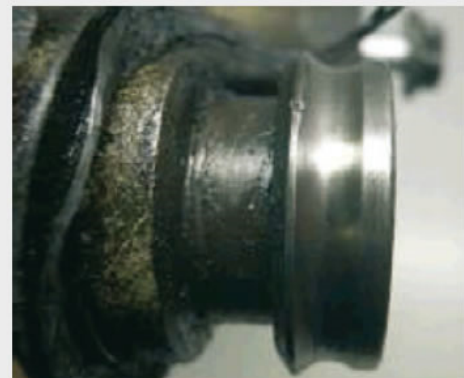
Știftul de ghidaj al plăcii opri-toare a scripetelui de tensionare
